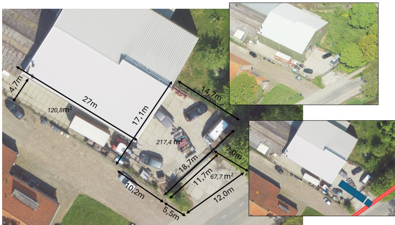
Figuur 3 – Afmetingen voorterrein huidige situatie met inzet 3D luchtfoto en situatie met indicatief standplaats van trekker-oplegger die geladen/gelost wordt
